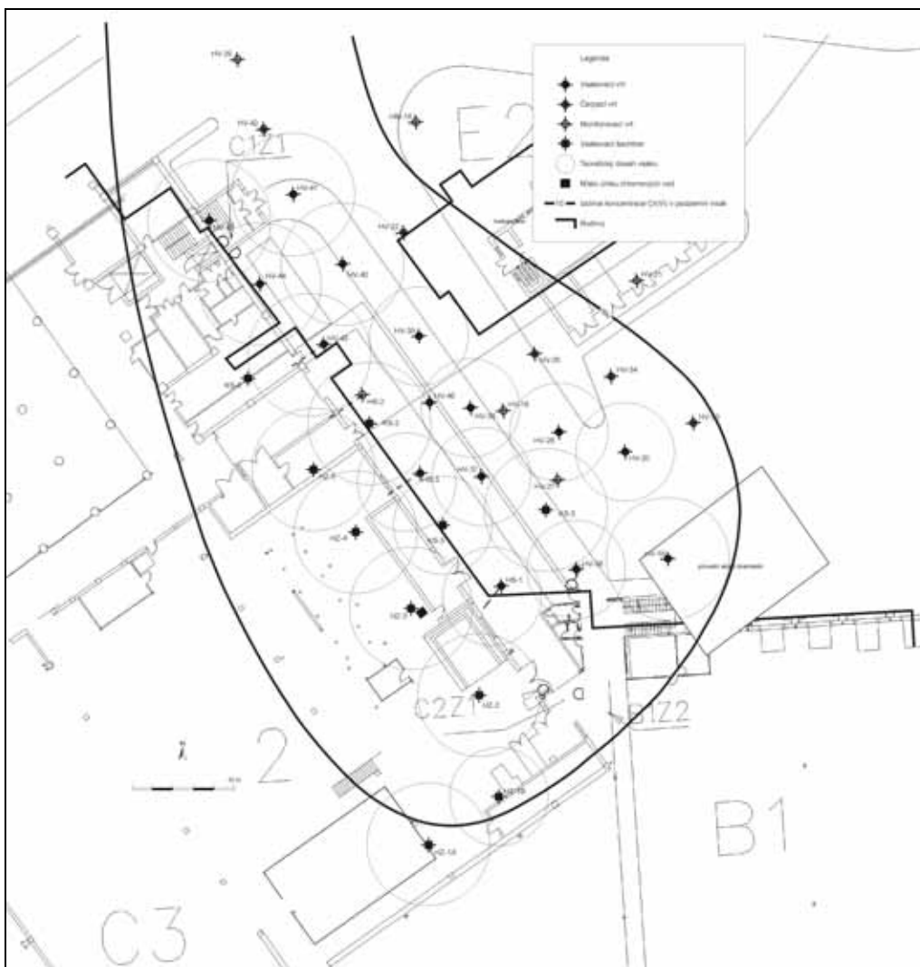
Obrázek 11 – Redukční stabilizace TK in situ, schéma zásaku redukčního roztoku
