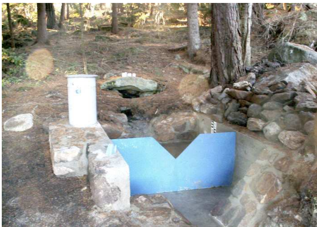
Obr. 9: Měřený pramen ČHMÚ s měrným přelivem
