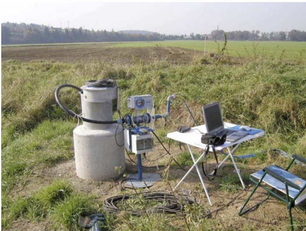
Obr. 16: Provádění hydrodynamických zkoušek (archiv T. Charvát). Vedle testovaného vrtu je vidět zařízení na měření průtoku a hladiny, výtlačné potrubí a přenosný počítač k sběru digitálních dat a jejich vyhodnocování.
