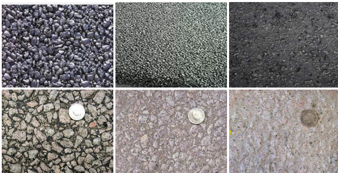
Obr.5.16.: Základní typy testovaných povrchů, v pořadí nahoře: PA, AR, AC, dole: SMA, C, TiO C
