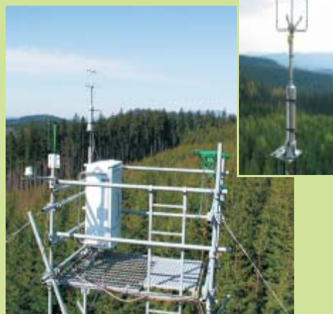
Eddy-kovarianční systém pro měření toku energie a látek mezi přízemní vrstvou atmosféry a ekosystémem
