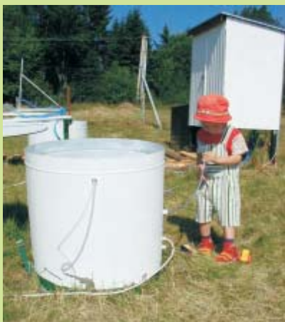
Systém automatického měření toku \text{CO}_2 z lučního porostu
