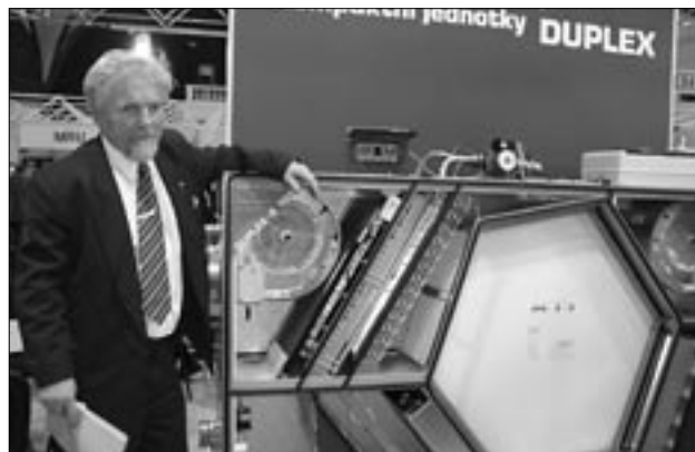
Ing. Morávek představuje klimatizační jednotku s protiproudým rekuperátorem tepla DUPLEX-S-1800
