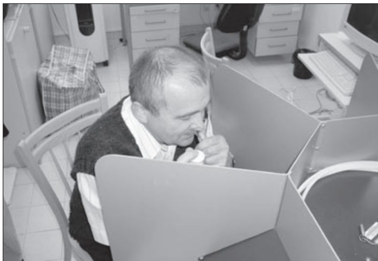
Měření koncentrace pachové látky se provádí v laboratoři dynamickým olfaktometrem Foto Jana Plamínková
