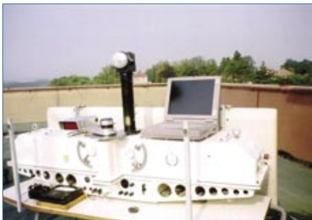
Obr. 2. Dobsonův spektrofotometr č.D074 používaný na SOO v Hradci Králové
