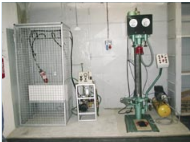
Obrázek č. 9: zařízení pro vytáčení ventilů tlakových nádob
