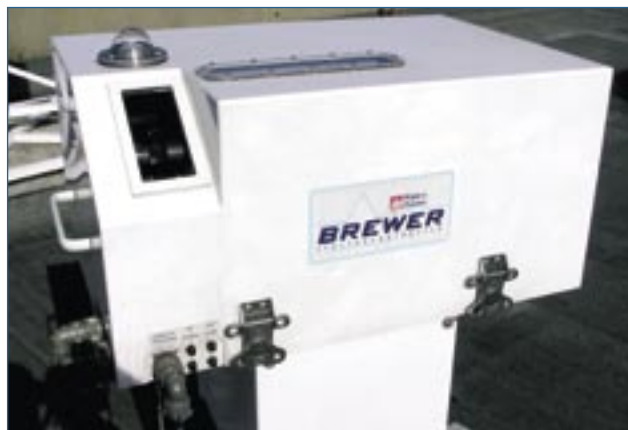
Obr. 3. Brewerův spektrofotometr č.B184 (MK-III) používaný na SOO v Hradci Králové
