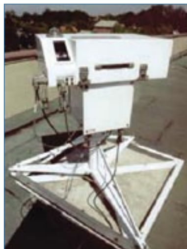
Obr. 1: Brewerův spektrofotometr na SOO Hradec Králové
