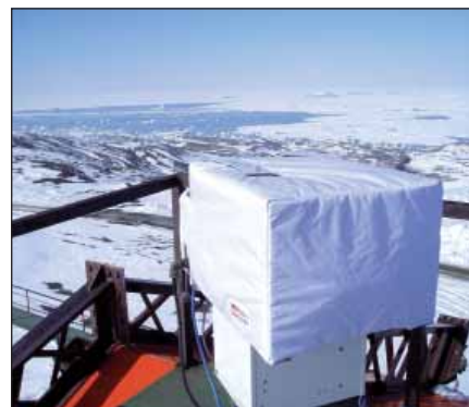
▲ Monitorování ozonové vrstvy na argentinské stanici Marambio pomocí Brewerova spektrofotometru jako příspěvek ČR k plnění Montrealského protokolu.
