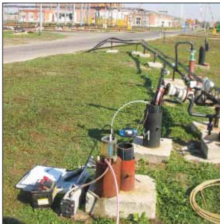
▲ Monitoring sanace, odběr vzorků pro laboratorní analýzy.
