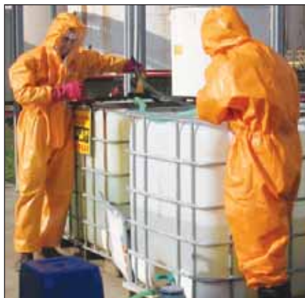
▲ Příprava roztoku oxidačního činidla v rámci pilotního pokusu.
