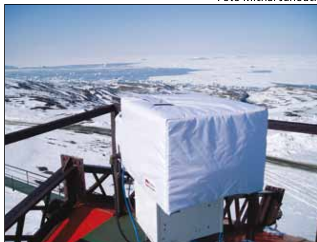
▲ Pracovníci Solární a ozonové observatoře ČHMÚ mají dlouhodobé zkušenosti s monitoringem stratosférického ozonu. V letošním roce zavedli dlouhodobé kvalitní měření v oblasti Antarktického poloostrova pomocí nejmodernějšího typu Brewerova spektrofotometru (na snímku) na argentinské stanici Marambio.
